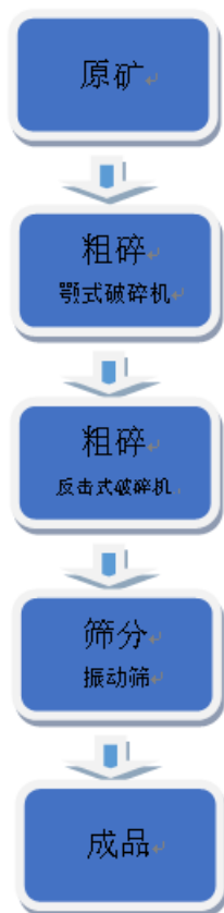
图 6-1 破碎工艺流程图
